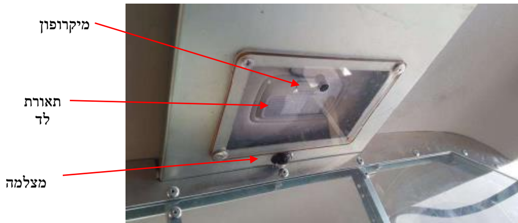
תמונה 9 דוגמא להתקנת מצלמה ומיקרופון
